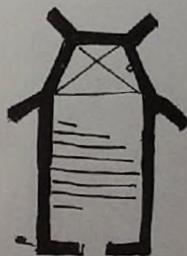
Bousval. — Chapelle du Tri au Chêne. Chœur voûté avec arcs à revers et arcs doubleaux. Nef avec voutains sur poutrelles.
