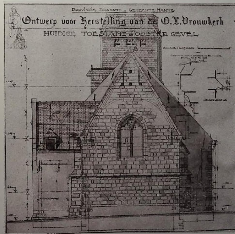
Eglise Notre-Dame à Hamme : façade latérale Est. Levé. (Photo 17)
