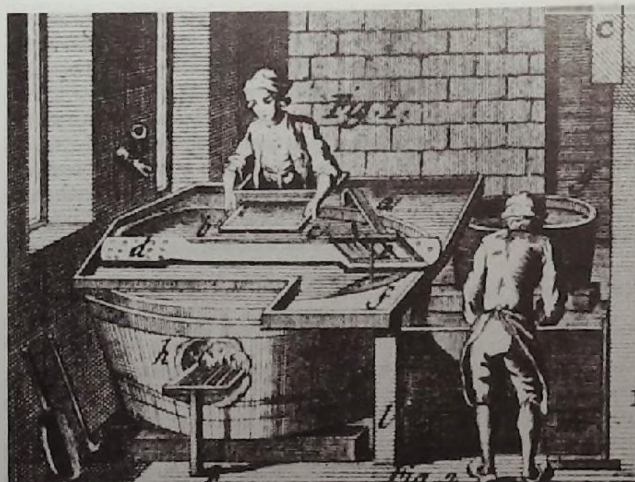
Représentation de la fabrication ancienne du papier à la forme.
