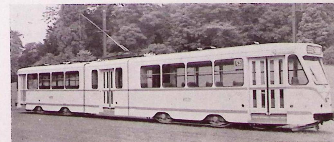
Motrice articulée à 4 essieux, construite de 1963 à 1966 en réutilisant les châssis, les trucks et l'équipement électrique de deux anciennes motrices à 2 essieux « Standard »
