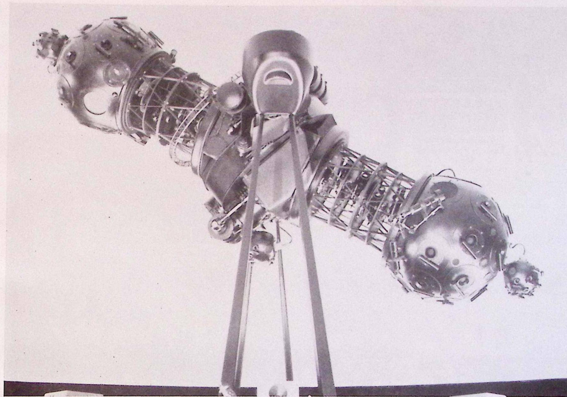
Le planétaire, fourni par la firme Zeiss à Jena, est équipé de 119 systèmes optiques et de 7 moteurs électriques.
