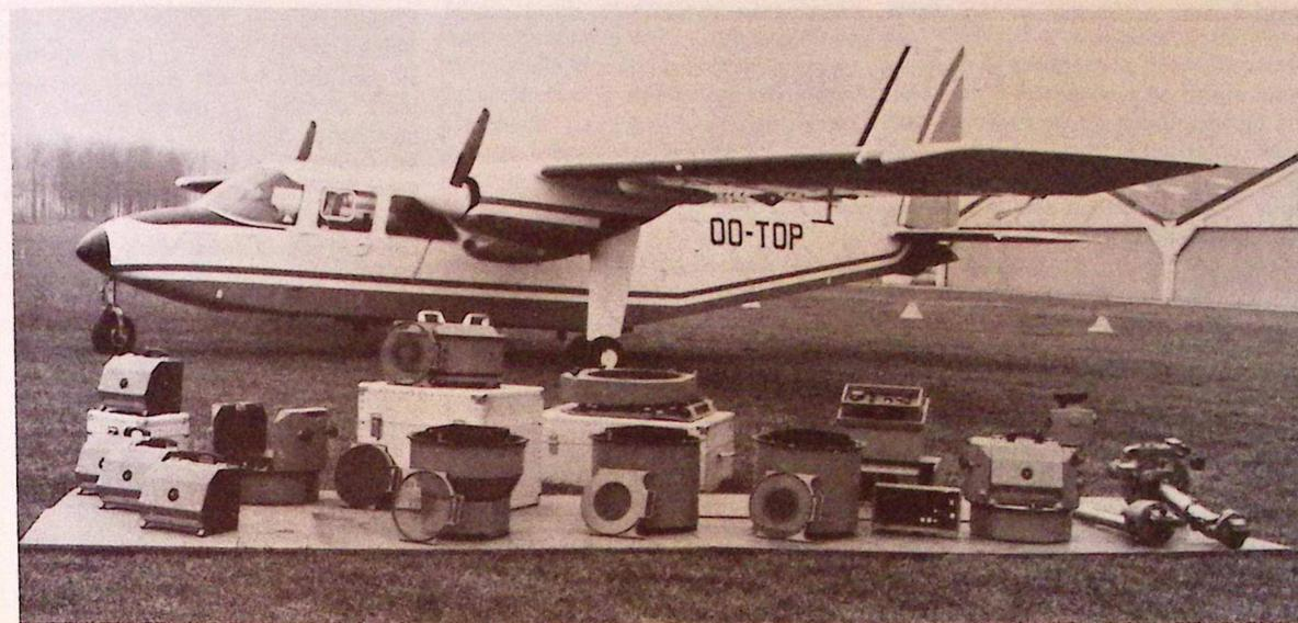
Voilà le matériel actuel d'une société d'aéroplanigrammétrie. Le bimoteur assure une stabilité suffisante à petite vitesse. A l'avant-plan, de gauche à droite, 4 magasins à film avec leur unité d'entraînement ; 4 objectifs avec leur « bague de serrage », le posémètre, la commande d'obturation ; enfin l'unité d'entraînement, l'intervallomètre et la lunette de navigation qui corrige automatiquement la dérive.
