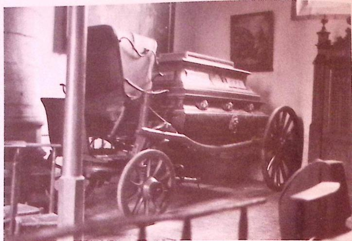
fication des essieux se fait avec des boîtes à graisse. L'axe est maintenu par des clavettes chassées à chaud. Il en est de même pour les roues avant qui cependant sont plus petites et à 10 rayons seulement.
