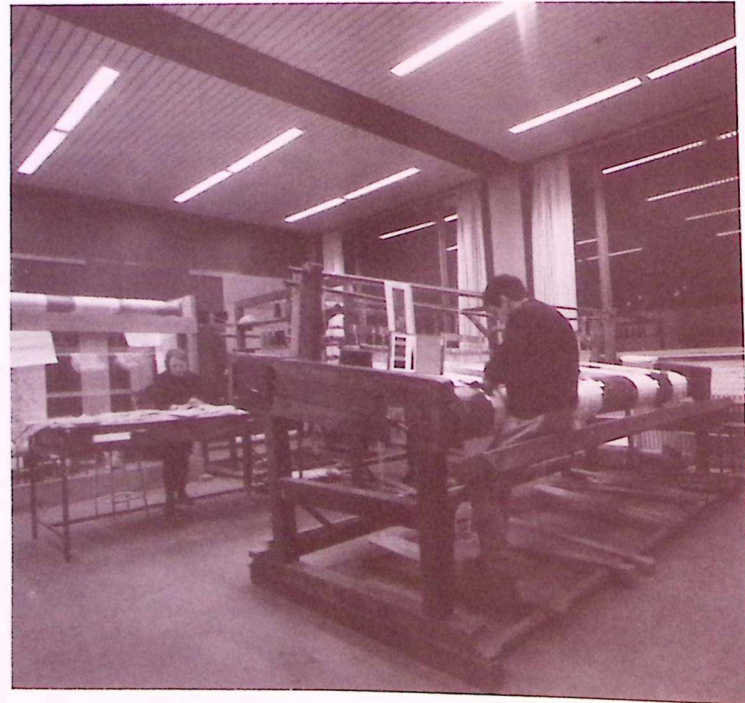
Les élèves préparent elles-mêmes le métier. Ici : montage des fils de chaîne. (photo fournie par l'Académie)
