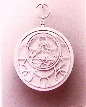
Astrolabe avec, au revers, un calendrier zodiacal, une table de rectification des heures et une alidade (mesure des angles verticaux). L'instrument provient de l'atelier louvaniste de Gemma Frisius, il est daté de 1558. (photo A. Burnet).
